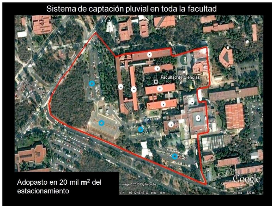
**Figura 1.** El sistema de captación de agua pluvial incluye a los edificios (circulo blanco c/ un punto) y los estacionamientos (circulo azul), el área total de 29,362 m<sup>2</sup>. El agua de lluvia se filtra por grietas hacia el acuífero den la Facultad.
