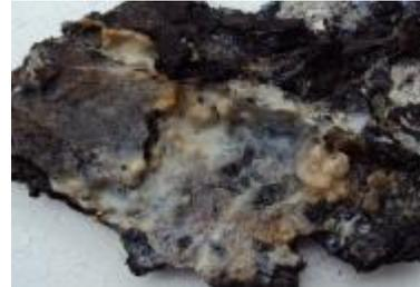
*Ilustración 20. Hongo en el material de recubrimiento que se está desprendiendo.*
