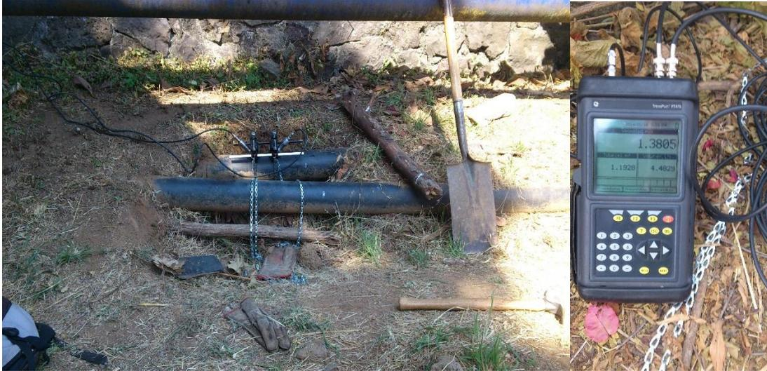
*Ilustración 37. Medición del suministro de agua potable con equipo ultrasónico portátil en el campus Morelos de la UNAM*
