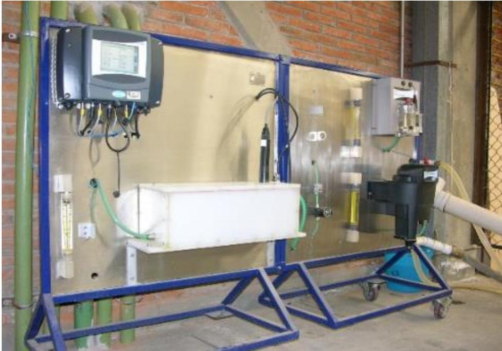
*Ilustración 4. Sistema de sensores de medición de calidad del agua en tiempo real, CU, UNAM. 2014*
