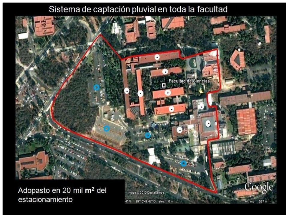
Figura 27. El sistema de captación de agua pluvial incluye a los edificios (circulo blanco c/ un punto) y los estacionamientos (circulo azul), el área total de 29, 362 m<sup>2</sup>. El agua de lluvia se filtra por grietas hacia el acuífero den la Facultad.
