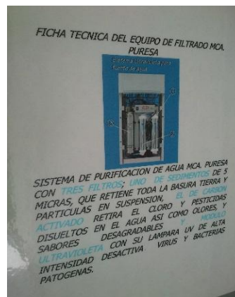
Dispositivo de tratamiento de tipo doméstico en tres etapas
