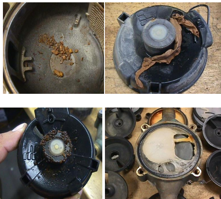
Figura 33. Incrustaciones en la cámara del medidor.
