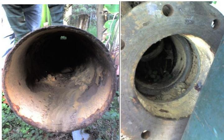
Figura 9. Diámetros e incrustaciones en las tuberías de agua potable
