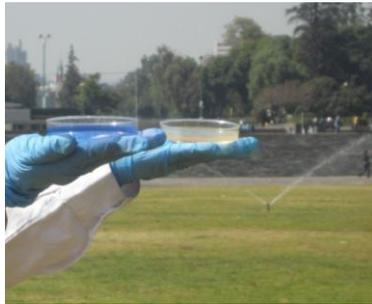
Monitoreo del aire en la zona de riego altura 1.40m
